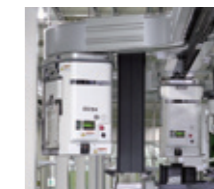
无尘室对应保管·搬运系统 - 半导体制造工厂使用的无尘搬运系统 - MCS(搬运控制·管理系统)
